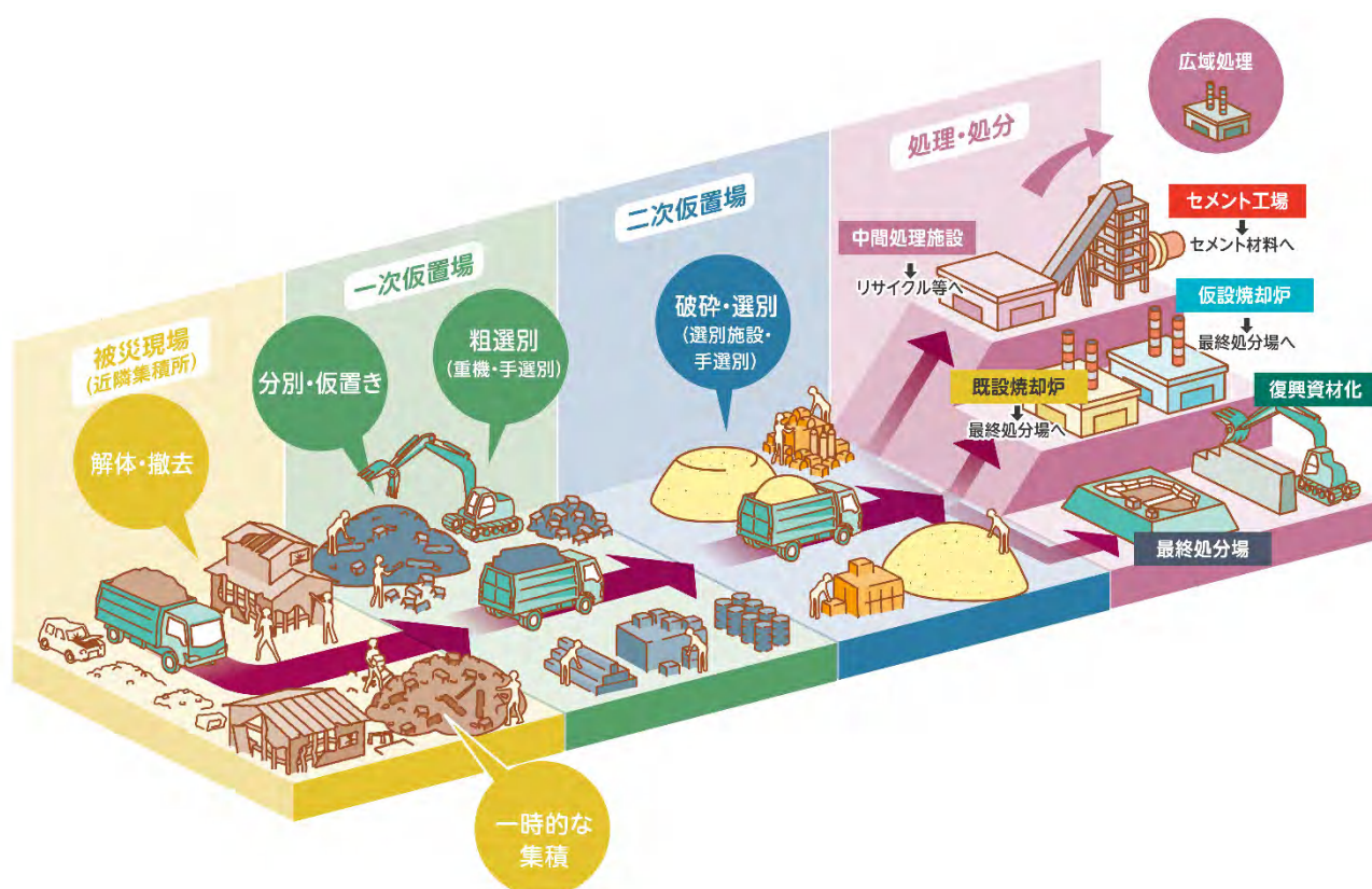
図 3-4 被災現場から仮置場までの流れ
