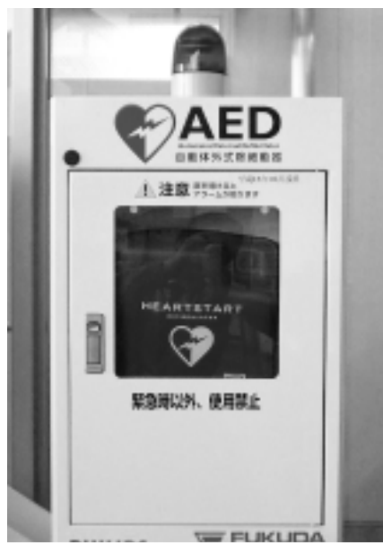
AED(自動体外式除細動器)…心肺停止状態の人の心臓に電気ショックを与えて、正常な状態に戻し、突然死を防ぐ機器です。
