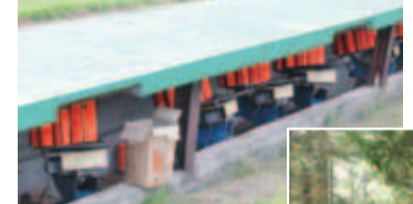
▲標的を射出する機械。オレンジ色が標的の皿(直径11cm)です ▶大会中、入口には多数の応援ののほりを設置
