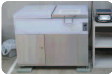
実証実験中の大型生ごみ処理機 幅98cm×奥行52cm×高さ80cm
