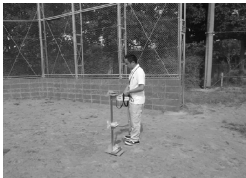
空間線量率の測定作業
