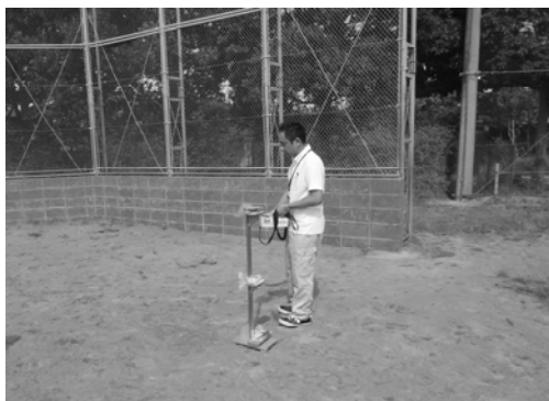
空間線量率の測定作業
