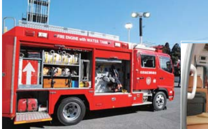
▲ 1,500L の水を積載し薬液を活用した消火活動が可能にした高機能装備車
