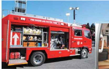
▲1,500Lの水を積載し薬液を活用した消火活動が可能にした高機能装備車
