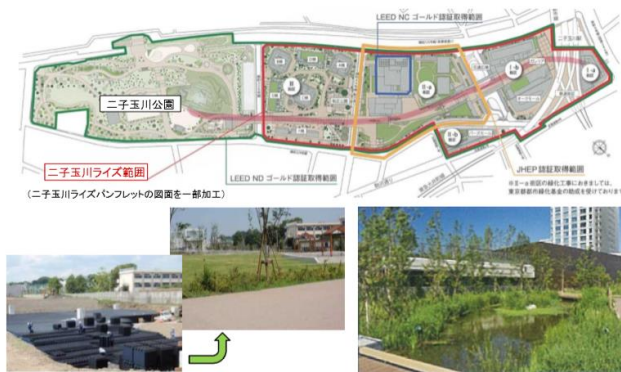
公園広場の地下に埋設されている雨水貯留施設 再開発により約6千㎡の屋上緑化など 約1万㎡を緑化 (二子玉川ライズパンフレットより引用)
