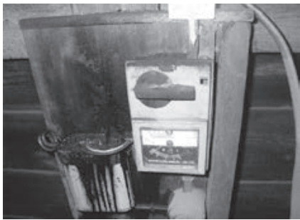
出火した低圧進相コンデンサ (1970年代の製品)
