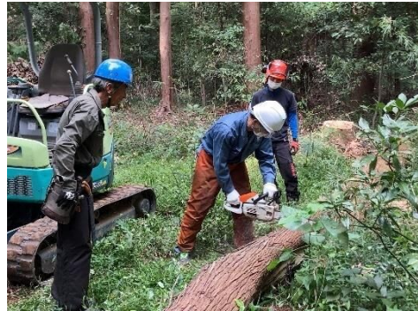
実習：チェーンソーの安全な玉切り作業
