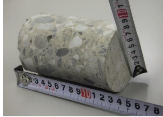
写真② 採取したコンクリート供試体
