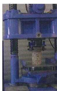
③試験機関における圧縮強度試験
