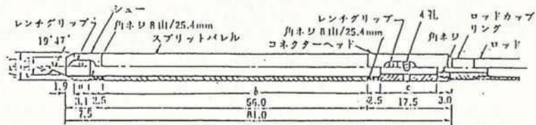
図1 標準貫入試験用サンプラー
