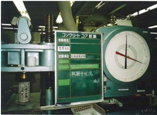
写真③ 圧縮強度試験
