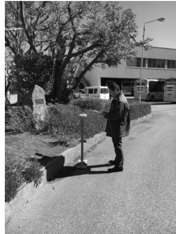
空間線量率の測定作業
