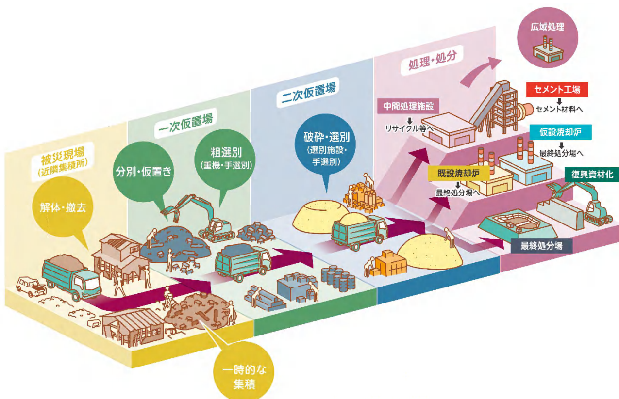
図 3-4 被災現場から仮置場までの流れ
