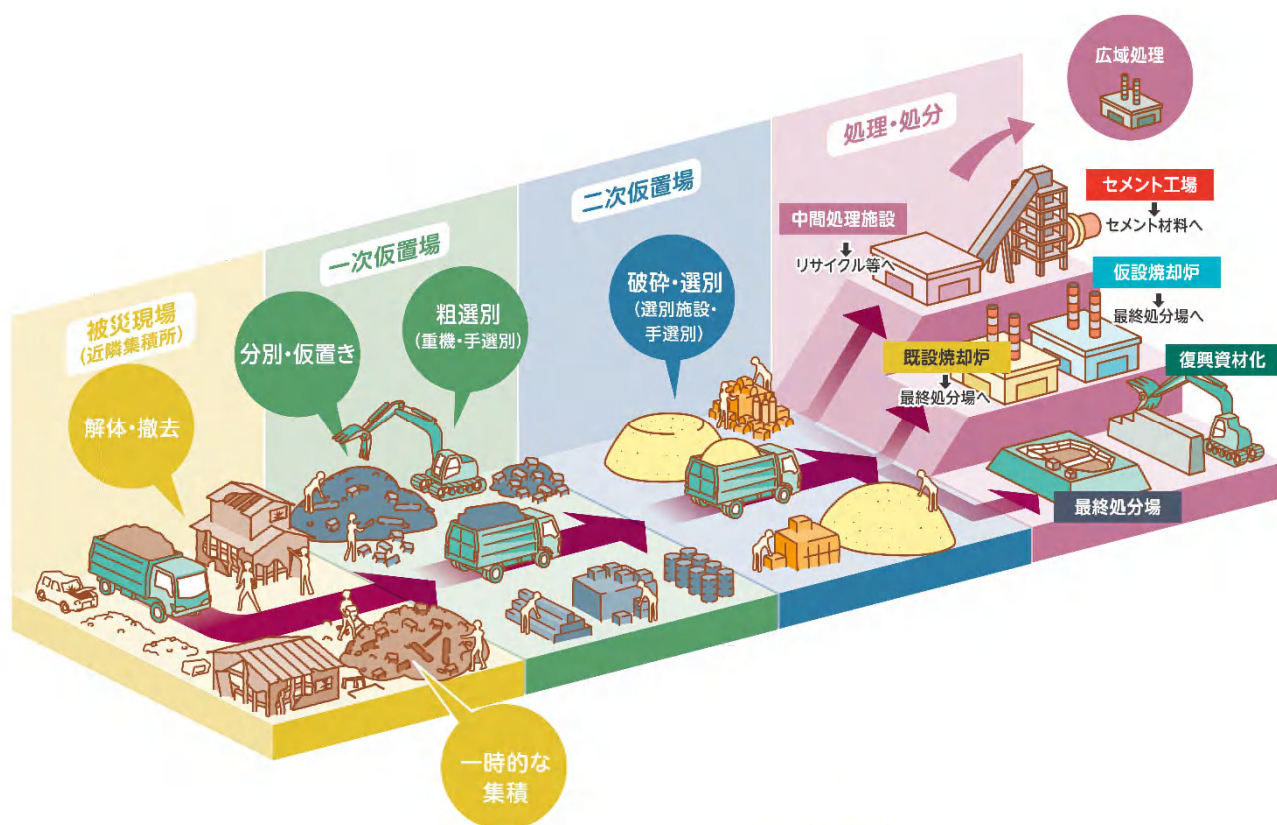
図 3-5 被災現場から仮置場までの流れ
