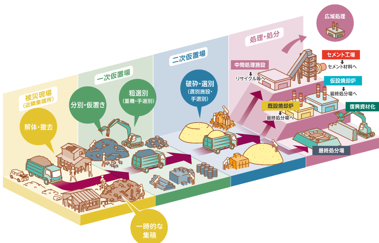
図 3-4 被災現場から仮置場までの流れ
