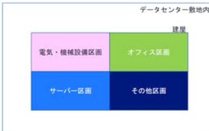
データセンターは重要なシステムや秘匿性の高いデータを扱うため、高いセキュリティが要求されています。一般的には敷地内、オフィス、電気・機械設備区画、サーバー区画などに分けられ、それぞれの区画ごとにアクセスするための資格が設けられ、セキュリティガードによる検査及びICカードその他機械的な認証を行うように設計されます。
